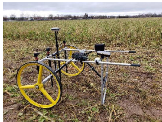
ABB. 1: MAGNETISCHES MESSGESTELL MIT 4 GRADIOMETERN (VORNE) UND RTK-DGPS AUSTRÜSTUNG (FA. VALLON).
