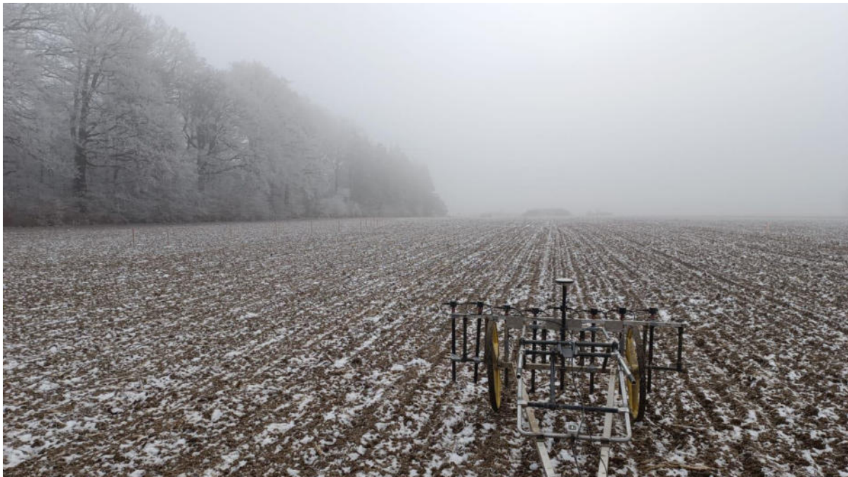
ABB. 1: DAS MESSGEBIET BESTEHT AUS LANDWIRTSCHAFTLICHER FLÄCHE MIT GEEIGNETEN WITTERUNGSBEDINGUNGEN FÜR MESSFORSCHRITT. DAS BILD UNTEN ZEIGT ZUDEHM DAS MESSGESTELL MIT 8 GRADIOMETERSONDEN.
