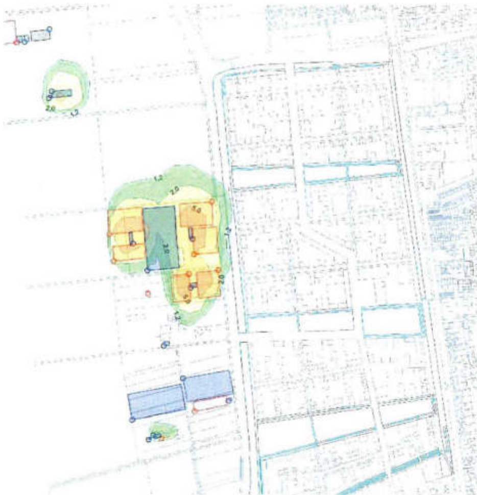
Abbildung 15: Staubkonzentration in \mu\text{g}/\text{m}^3 - Isoliniendarstellung
